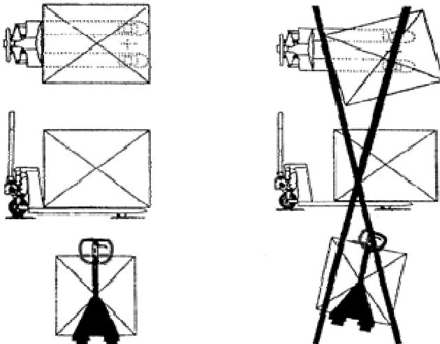
Груз должен располагаться так, чтобы вес равномерно распределялся на обе вилы.
