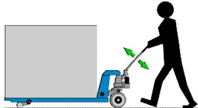
Груз поднимается при движении ручки гидравлической тележки.
